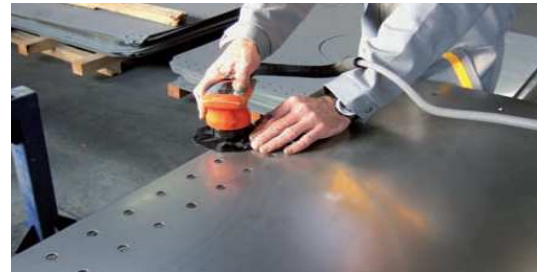
Обработка и закругление кромок панелей
