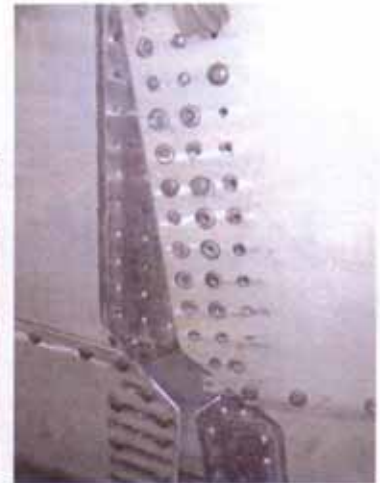
Bild3: Blech 3-reihig Bruch bei 4050kN
